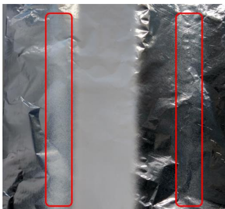
Figura IV- 5. Vista macroscópica de NFs de PCL con NPs de SBA-15 incorporadas mediante electrospraying simultáneo
