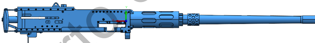
Fig 4-6. Vista lateral de ametralladora M2HB, Sistema de referencia y centro de masas.
